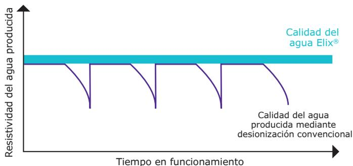
El diagrama muestra la superioridad de la tecnología Elix® con respecto a los sistemas que utilizan módulos de resinas de intercambio iónico. La resistividad cae enormemente cuando los módulos están agotados.
