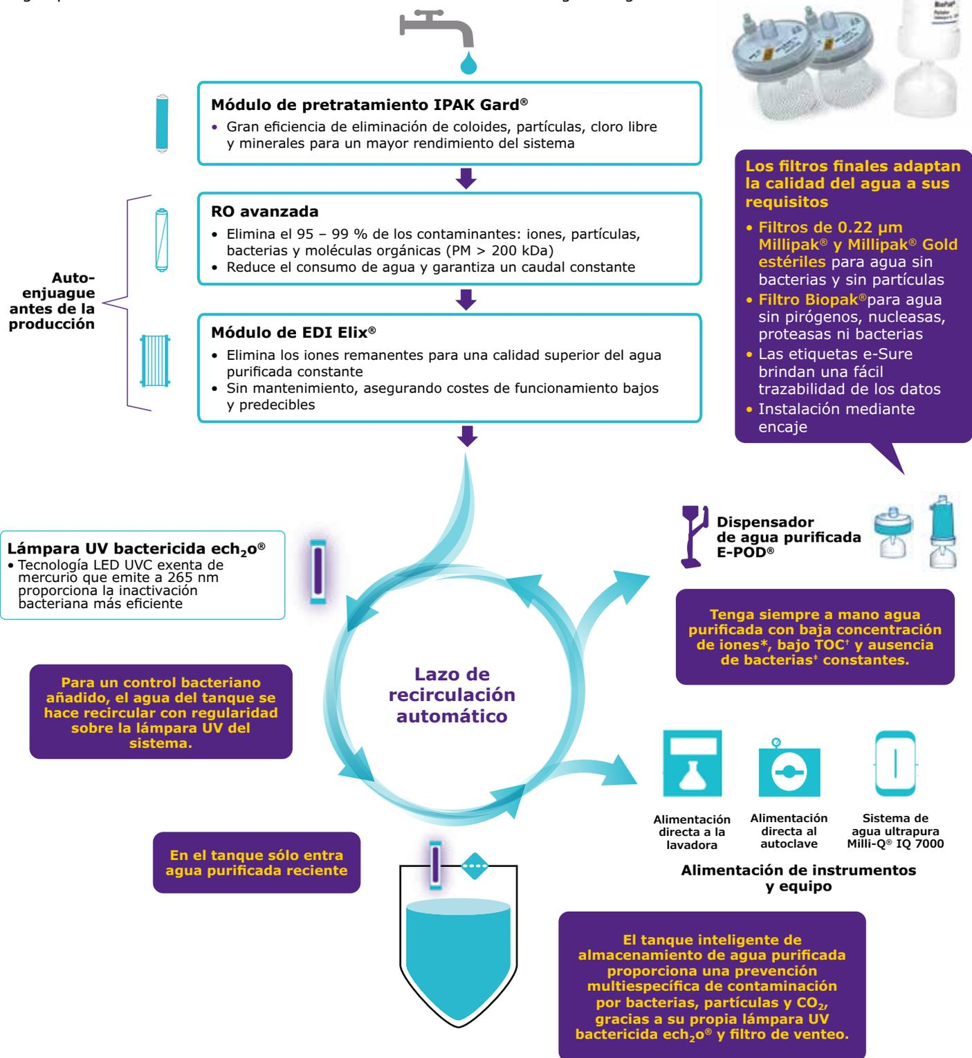
\* Resistividad >5 MΩ·cm a 25°C, normalmente 10-15 MΩ·cm; † TOC ≤ 30 ppb; ‡ Bacteria <0,01 ufc/ml con filtros Millipak® o Millipak® Gold o ultrafiltros Biopak® cuando se instalan y se utilizan en una campana de flujo laminar; ASM, módulo de desinfección automática; EDI, electrodesionización; Hg, mercurio; RO, ósmosis inversa; TOC, carbono oxidable total
