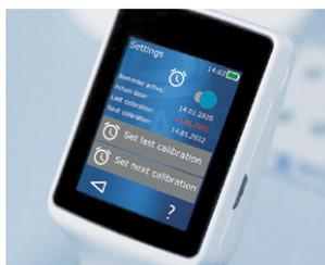
Configuración de un recordatorio para la siguiente calibración
